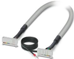
Konfektioniertes, geschirmtes Rundkabel; Anschluss 1: IDC/FLK-Buchsenleiste (1x 16-polig); Anschluss 2: IDC/FLK-Buchsenleiste (1x 16-polig) (Das Schirmgeflecht ist auf ein separates Kabelende herausgeführt.); Kabellänge: 0,5 m
