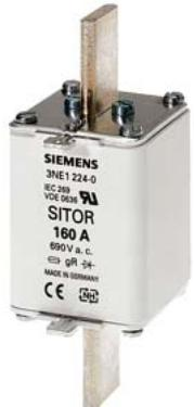
SITOR fuse link, with blade contacts, NH1, In: 160 A, gR, Un AC: 690 V, Un DC: 250 V, front indicator
