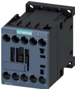
Contactor de potencia, AC-3 16 A, 7,5 kW, 400 V 2 NA + 2 NC 110 V DC 4 polos tamaño S00 conexión por tornillo
