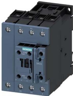
Contactor de potencia, AC-3 40 A, 18,5 kW/400 V 2 NA + 2 NC 42 V AC, 50 Hz 4 polos tamaño S2 conexión por tornillo 1 NA + 1 NC integrados
