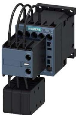
Contactor para condensador, AC-6b 12,5 kVAr, /400 V 2 NC, 24 V DC 3 polos, tamaño S00 conexión por tornillo
