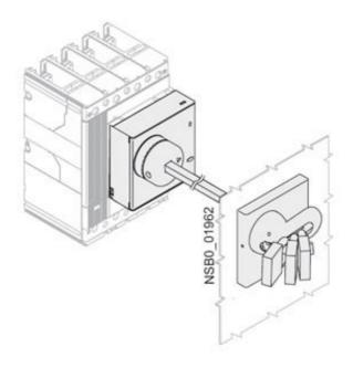
ROTARY LEVER OPERAT.MECHANISM WITH LOCK/DOOR INTERLOCKING FOR FRAME SIZE 3RV1. 6, 7
