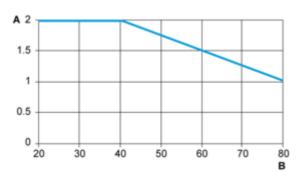
A : Load Current (Amperes) B : Ambient Temperature (°C)
