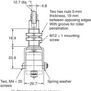
ZAQ-22 Z-15E-B DZ-10G-1B OF max. 8.34 N 11.1 N RF min. 1.12 N 1.12 N PT max. 2 mm 2 mm OT min. 3.58 mm 1 mm MD max 0.15 mm 0.46 mm OP 37±0.8 mm 35.4±1.2 mm
